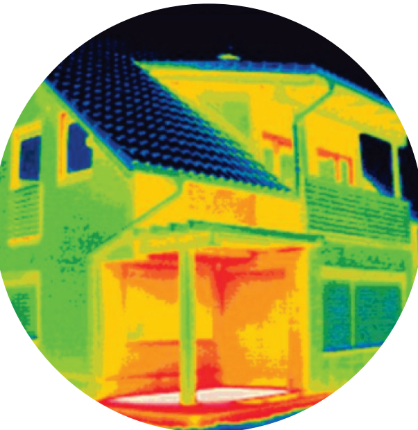
Hőkamerás kép, amely megmutatja a hőveszteségek egymáshoz viszonyított nagyságát, színekkel ábrázolva.
